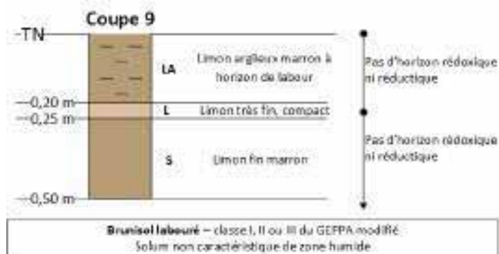
Figure 17 : coupe pédologique des sondages S16, S19, S20 à S25, S27 à S38 (réalisation : Naturalia Environnement)
